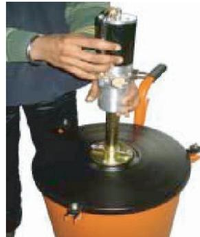
3. Empuje hacia abajo el ensamble de la bomba hasta que el fondo de la bomba toque la base del tambor. Ajuste la tapa del tambor y apriételo con los tornillos de apriete manual surtidos con la tapa del tambor.
